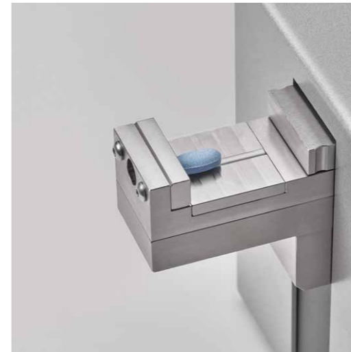
带凹槽的快换舌板，便于对齐凸形片剂
