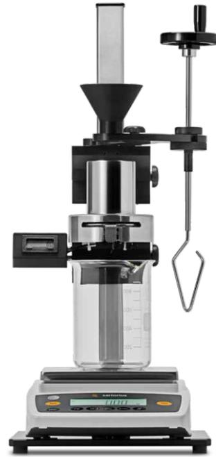
使用量筒进行固定孔流动测试
