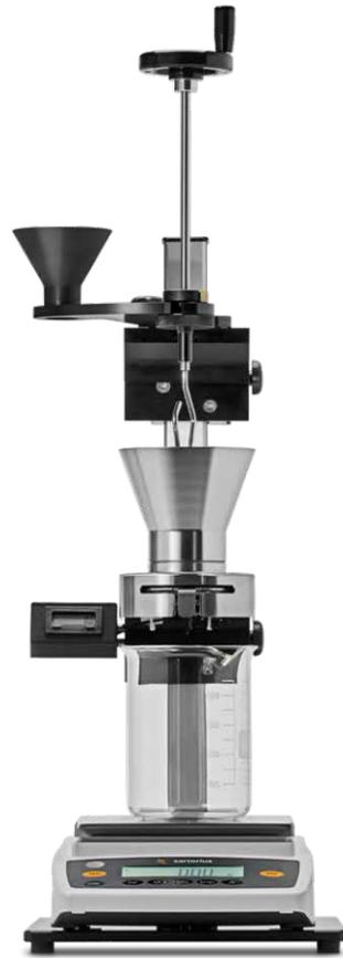
使用漏斗进行固定孔流动测试
